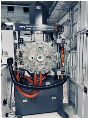
Bild 3: MTC-Creep (links) und MTC-Uniax (rechts) Prüfstand (Lastrahmen mit integriertem Druckbehälter) im Zustand vor der Montage der Messtechnik
