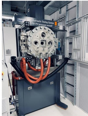
Bild 3: MTC-Creep (links) und MTC-Uniax (rechts) Prüfstand (Lastrahmen mit integriertem Druckbehälter) im Zustand vor der Montage der Messtechnik
