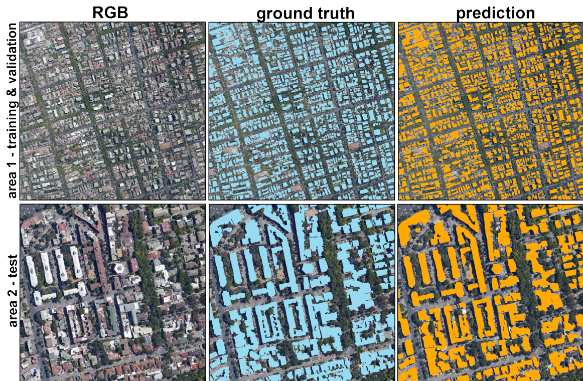
Abbildung 6.1: Vergleich der originalen RGB-Daten (links), der Ground-Truth-Daten (mittig) und der Klassifikationsergebnisse der Gebäudeextraktion des angepassten Modells (rechts) für Gebiet 1 (oben) und Gebiet 2 (unten) (Stiller et al., 2019b).
