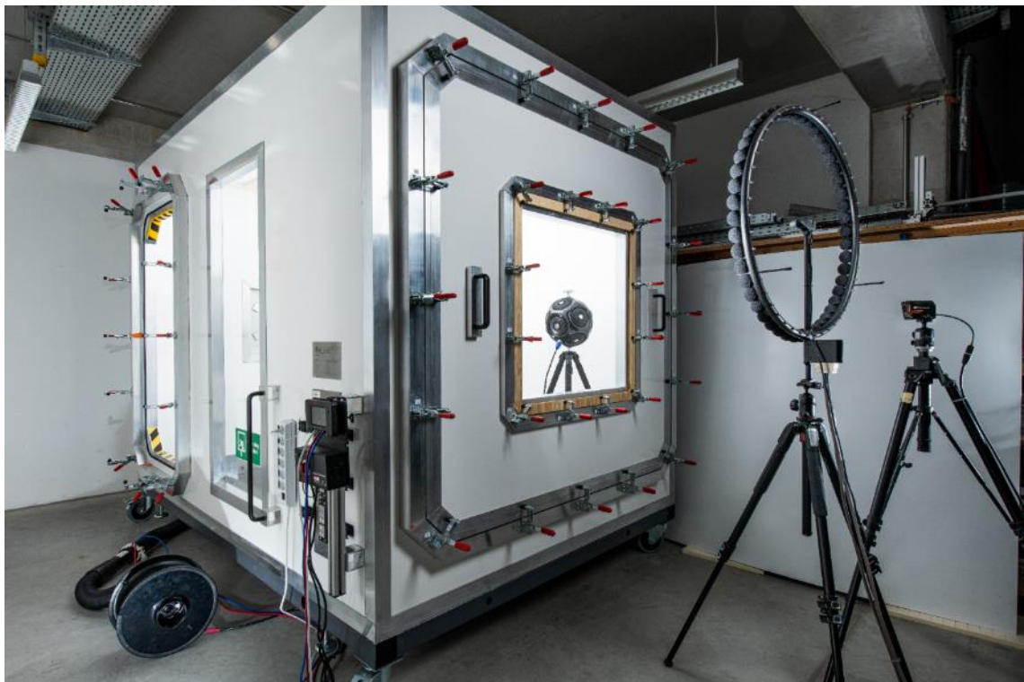
Abbildung 3-1: Prüfstand ATLAS mit erforderlicher Messtechnik: Micro Leakage Meter (links), Lautsprecher (innen) und Mikrofonarray (rechts)
