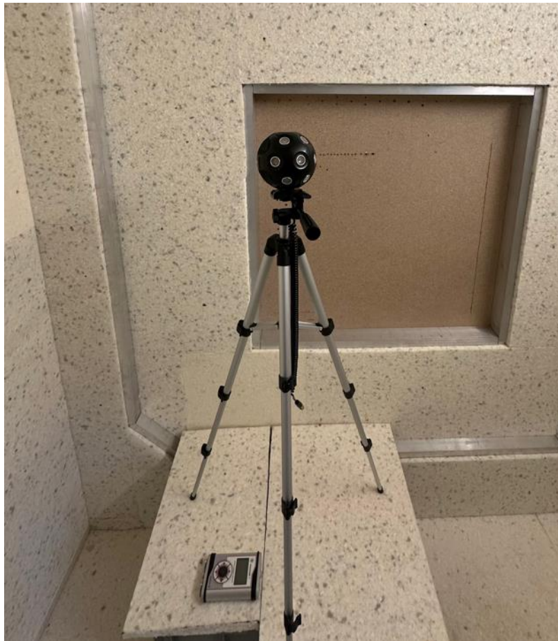
Abbildung 3-12: SONAPHONE T in Kombination mit der SONOSPHERE im inneren des Prüfstandes
