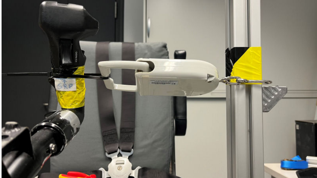
Abbildung 4.4.: Kalibrierungs-Messung einer Richtung der Rollachse
