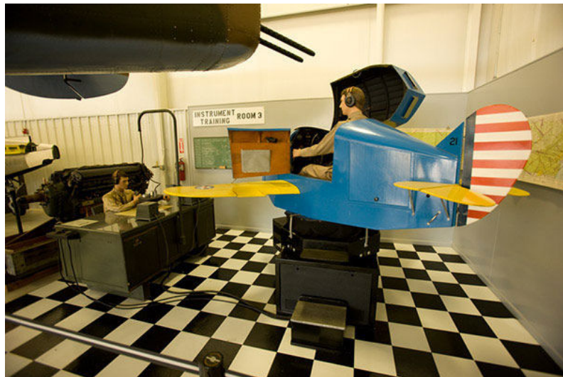
Abbildung 2.1.: Der Flugsimulator „Link Trainer“ [3]
