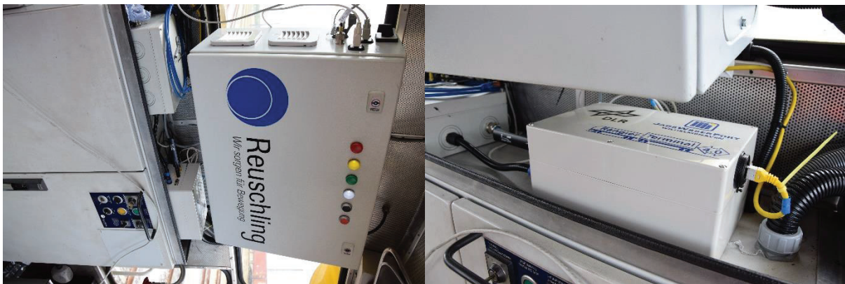
Abbildung 6: Hardwarekomponenten (links) und Ortungseinheit (rechts) im Führerstand der Rangierlok.
