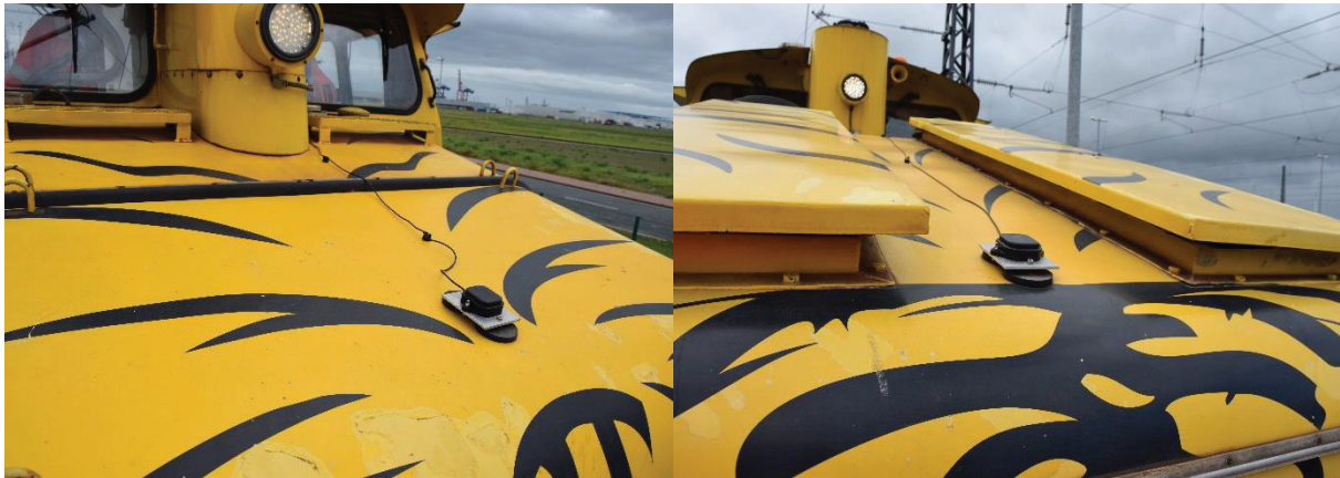
Abbildung 5: GNSS-Antennen der Ortungseinheit auf der Rangierlok.
