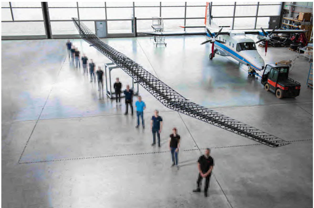
Abbildung 11: Die Teststruktur des Versuchsflügels des Luftfahrzeugs HAP- \alpha
