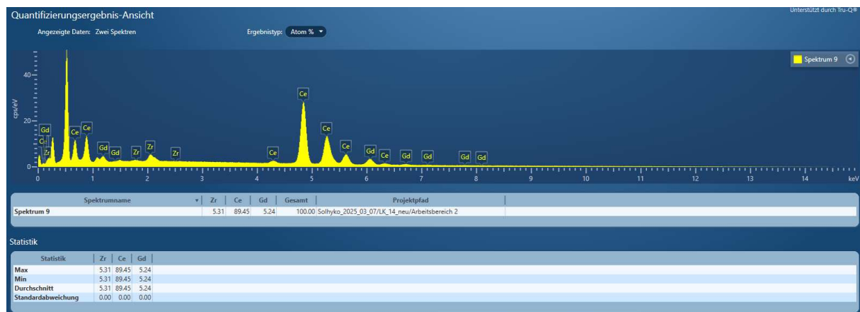
Abbildung A. 0.6: Auswertung EDX-Flächenscan eines gesinterten \text{CeGd}_5\text{Zr}_5 -Pellets im Querschnitt nur für Ce-, Gd- und Zr-Signale.
