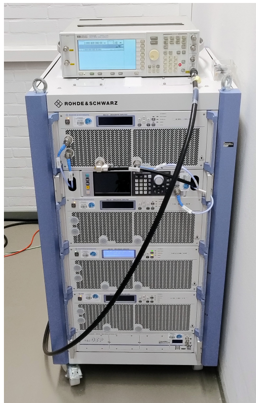
Abbildung 14: Aufbau zur Signalerzeugung außerhalb der EMV-Kammer
