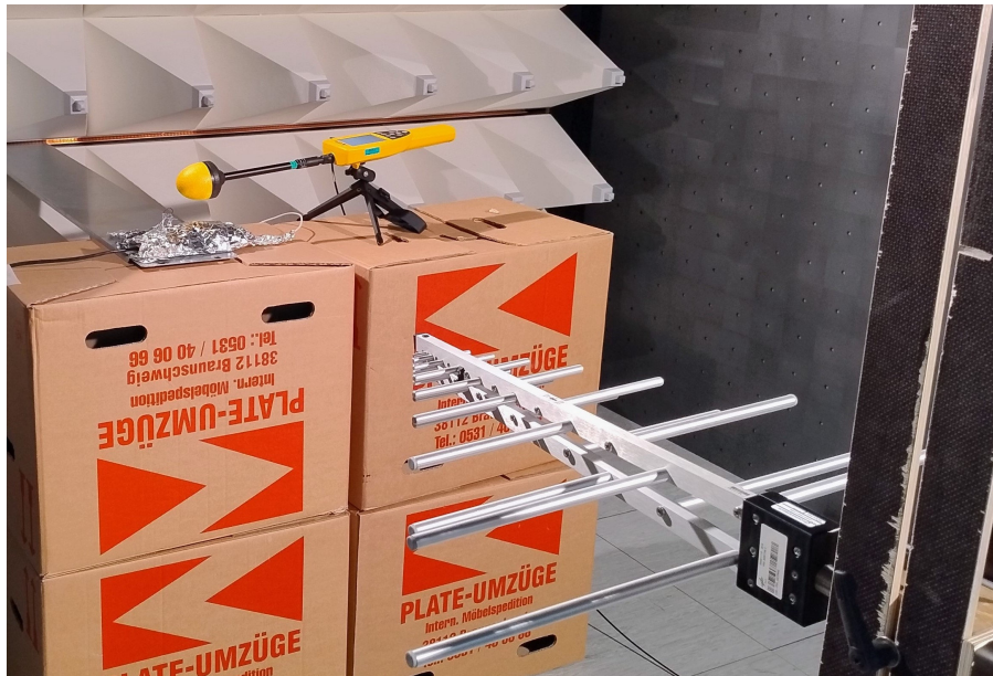
Abbildung 17: Aufbau zur Bestrahlung der IMU
