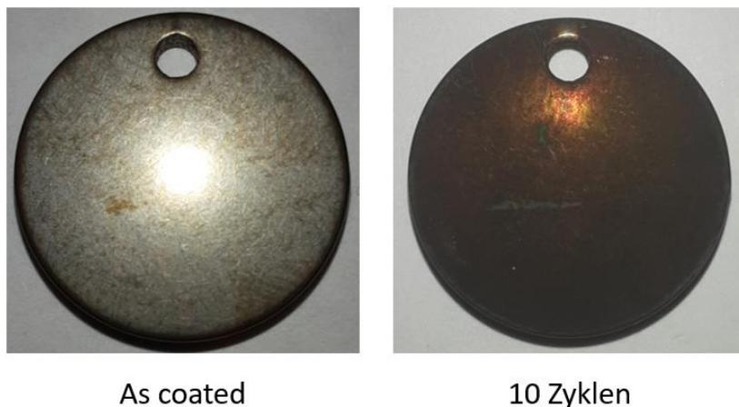
Abb. 4.20: Makro Aufnahme der mit  $\text{Cr}_2\text{AlC}$  beschichteten  $\gamma\text{-TiAl}$  Proben nach 10h bei einer Temperatur von  $700^\circ\text{C}$  im Vakuum (links) und nach 10h bei einer Temperatur von
