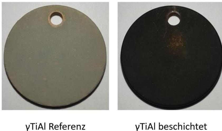
Abb. 4.31: Vergleich der unbeschichteten (links) und beschichteten (rechts) TiAl 48-2-2 Proben nach 1000 Oxidationszyklen bei  $850^\circ\text{C}$ .
