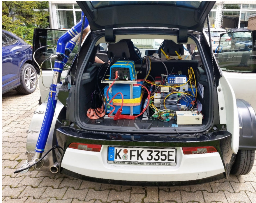
Stromversorgung, Datenlogger und Wandler
