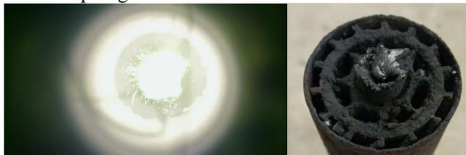
**Abbildung 7.** Der Versuch DLR-003: (links) Pulver  $\beta$  zündet sofort nach dem Glühen. (rechts) Es kam rasch zu einer Schlackenbildung, und dadurch zu einer Verstopfung des Brenners
