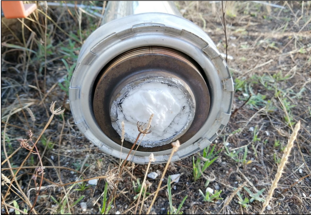
Abbildung 2.8.: Receiverrohr mit auskristallisiertem Salz infolge einer mangelhaften Drainage [35]
