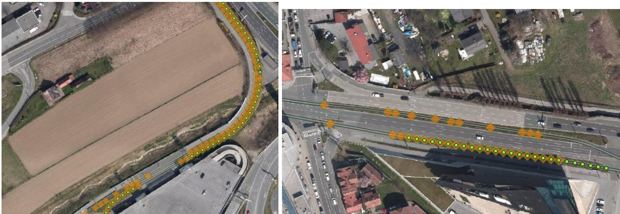
Abbildung 38. Vergleich von als Grüngleis klassifizierten Stellen (orangene Rechtecke) und Grüngleis in den Trainingsdaten (grüne Punkte) an zwei Streckenabschnitten in Graz. Quelle ist ein Orthophoto erhalten von [geodaten.graz.at](http://geodaten.graz.at).
