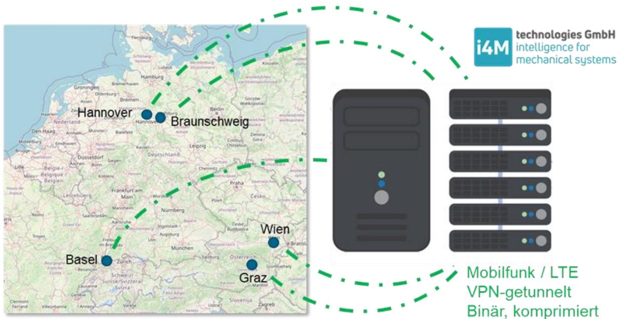
Abbildung 11. Schematische Darstellung des Datenhandlings im Projekt OnboardEU über das zentrale Datenmanagementsystem der i4M technologies GmbH.
