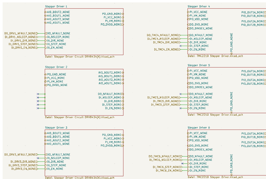
Abbildung 7.16: Schaltplanblatt „Dosing Pumps“ mit sechs Schrittmotoren
