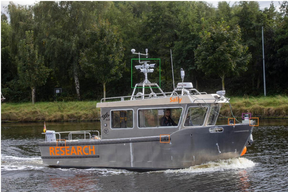
Abbildung 17 Foto des Testträgers Sally mit den verbauten 1D-FMCW-Radaren (orange umrandet), dem LiDAR (violett umrandet) und den Kameras (grün umrandet)
