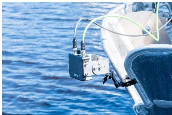
Abbildung 19: 1D Radar Sensor am Bug des Testschiffs Sally.
