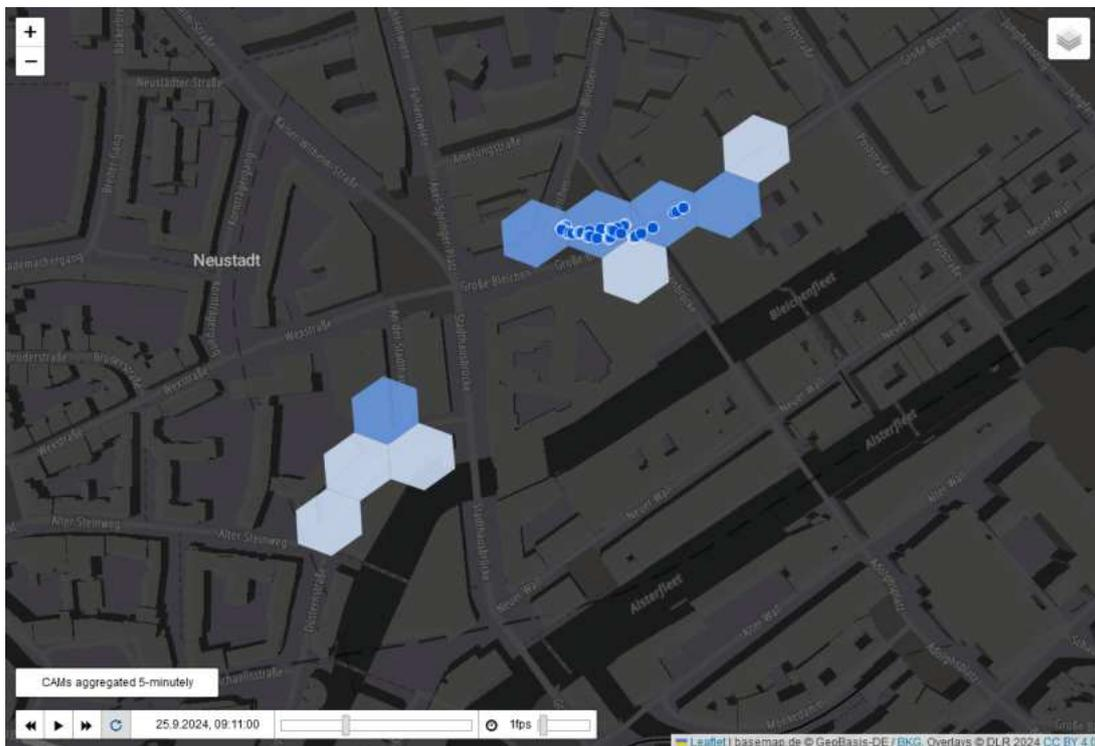
Abbildung 31: Kartendarstellung aggregierter CAM-Nachrichten als Verkehrsstärke. Zunehmende Farbintensität bedeutet ein größeres Verkehrsaufkommen. Die Polygone sind mit Angabe eines zeitlichen Filters über standardisierte OGC-Schnittstellen abrufbar.
