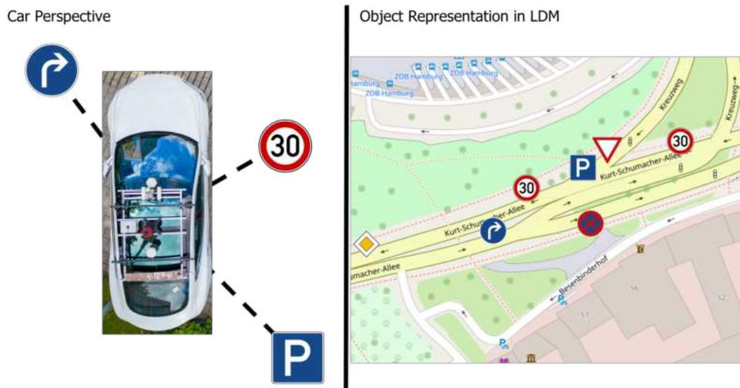
Abbildung 10: Funktionsweise der Lokalisierung auf Basis von Landmarken
