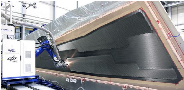
GroFi® - Großstrukturfertigung mittels Automated Fiber Placement und Tape Laying – als Ergänzung und Team (Multi-Robot)
