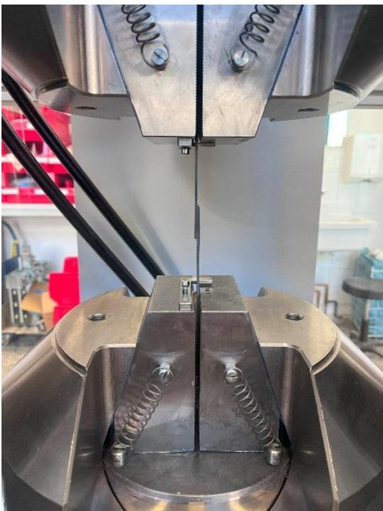
Abbildung 45: SLS bei Raumtemperatur
