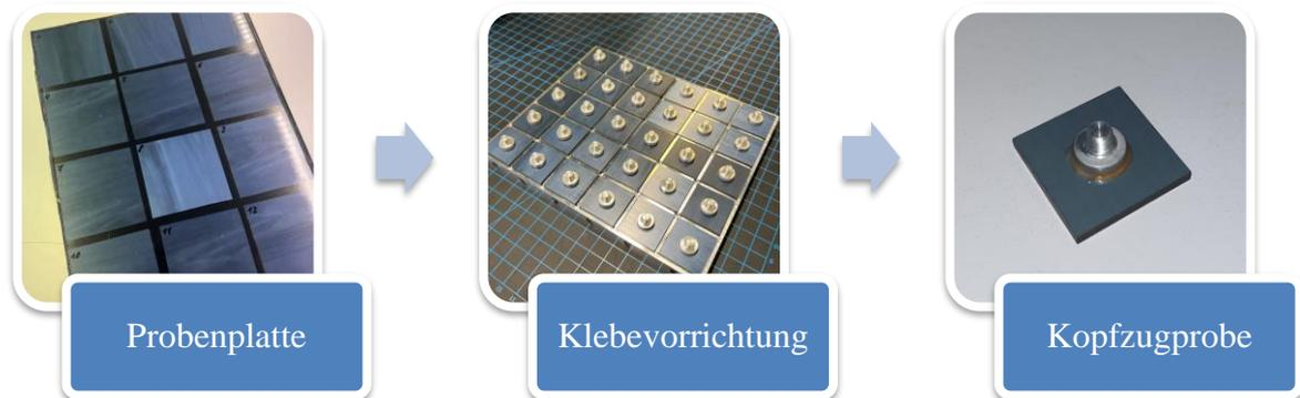
Abbildung 38: Kopfzugproben Fertigungsverlauf
