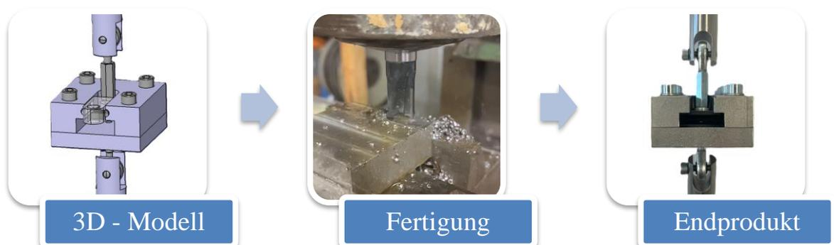
Abbildung 39: Kopfzugvorrichtung
