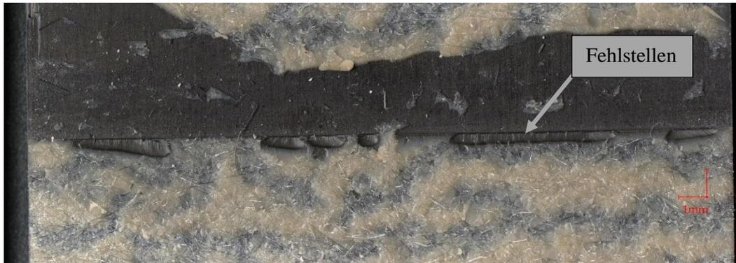
Abbildung 18: Verklebte CFK-Oberfläche [DLR]
