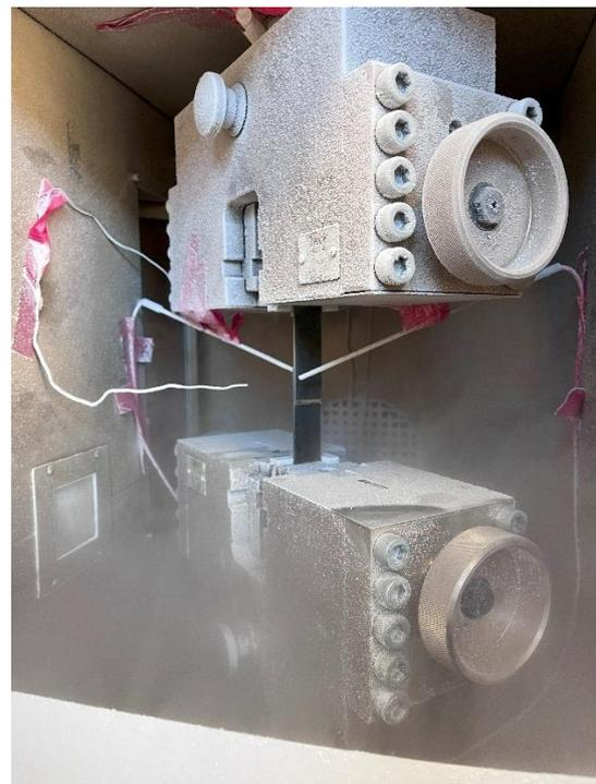
Abbildung 46: SLS bei -55°C
