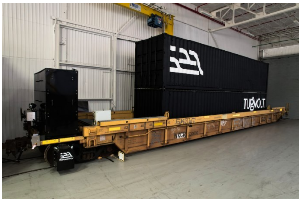
Abbildung 3 – Selbstfahrender Güterwagen der Fa. Intramotiv, ausgerüstet mit dem TugVolt System (4)
