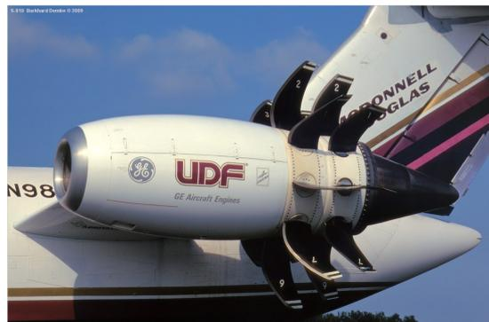
Abbildung 1.7: Propfantriebwerk mit gegenläufigen Propellern [13]
