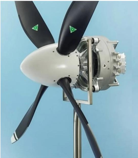
Abbildung 1.2: Herkömmliches Design eines Propellers mit einer elektrischen Maschine und einer Welle [5]
