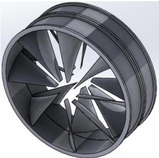
Abbildung 1.6: Konzept eines gegenläufigen Propellers in ringförmiger Ausführung [4]
