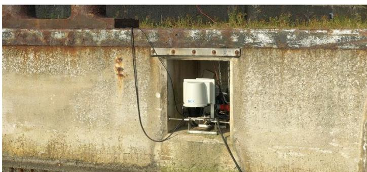
Abbildung 4 - Installation eines 2D-LiDAR in der Kaimauer in WHV
