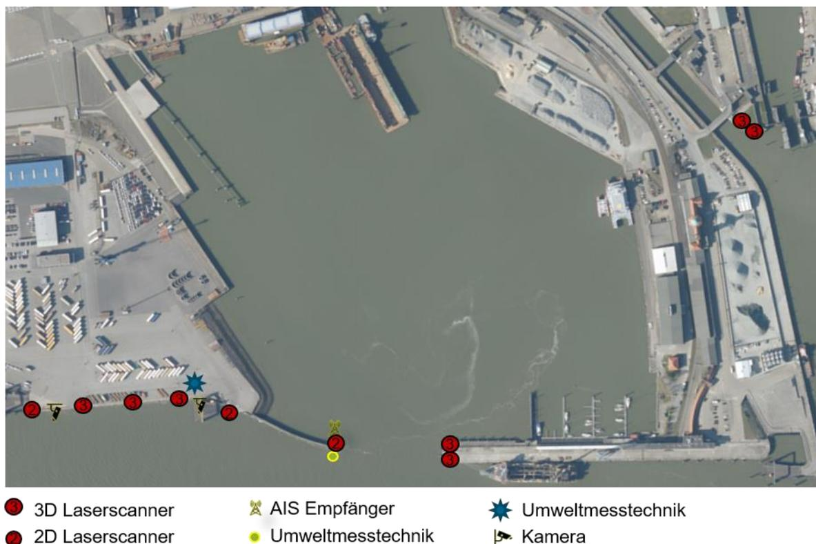
Abbildung 6 - Aufbau des Testfelds mit eingezeichneten Sensorpositionen, Kartenmaterial ist ein Auszug aus den Geodaten des Landesamtes für Geoinformation und Landesvermessung Niedersachsen ©2023
