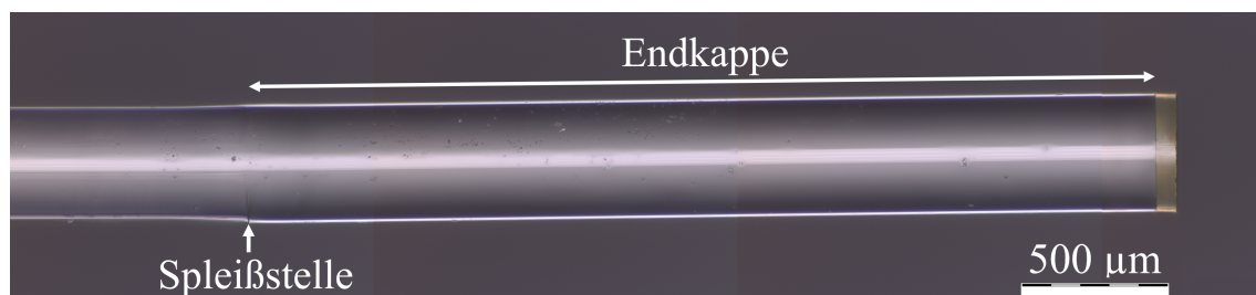
Abbildung 5.11.: Mikroskopische Aufnahme der Faserendkappe. Vom linken Bildrand führt die LMA-Faser ein, an der die Endkappe angespleißt ist. Am rechten Ende ist, leicht gelblich gefärbt, die 3D gedruckte Linse zu erkennen.
