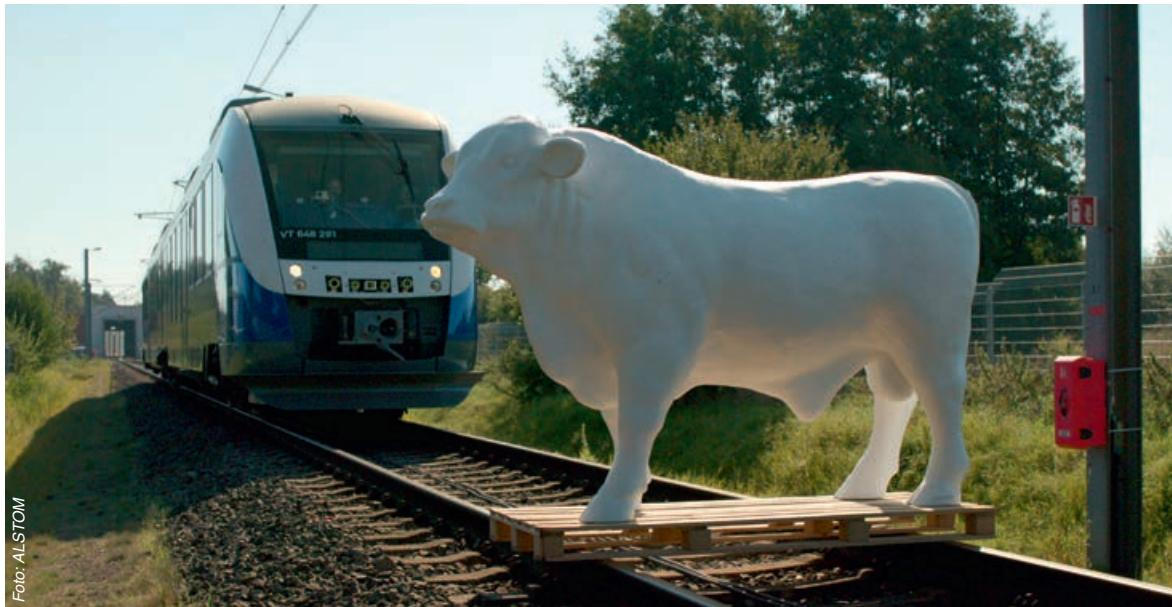
*Große Tiere auf dem Gleis sind eine Gefahr für Schienenfahrzeuge: die Hinderniserkennung bringt den Zug sicher zum Halten*
