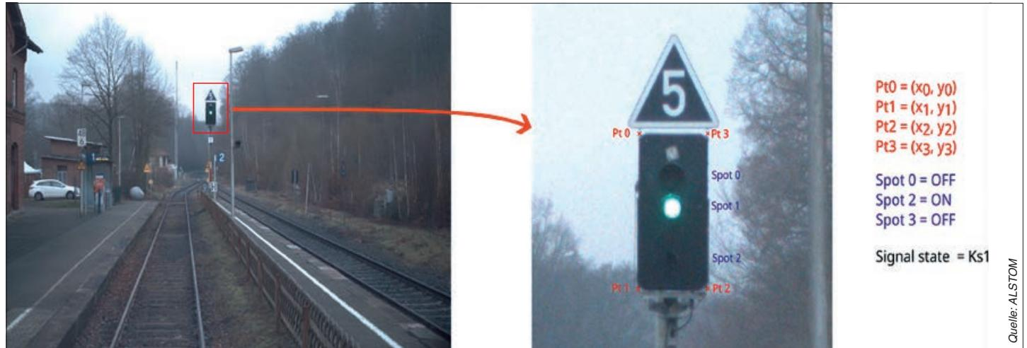
Damit die Signalerkennung ein Signal sicher erkennen und lesen kann, müssen Umrisse und Lichtpunkte genau vermessen und die möglichen Zustände (Signalbilder) hinterlegt werden
