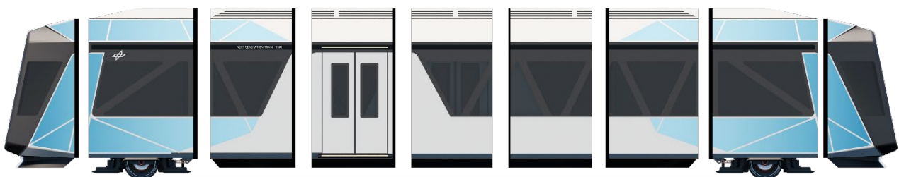
2: Prinzip der Längenrasterung bei der modularen Fahrzeuggestaltung
