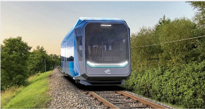
1: Kleines, leichtes, modulares und automatisiert fahrendes NGT-TAXI mit lokal emissionsfreiem Antrieb
