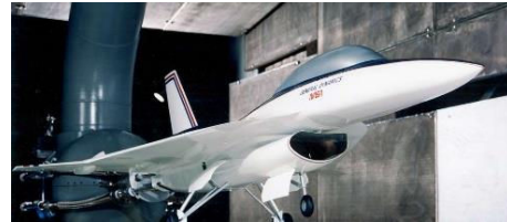
Abb. 14: F-16 Modell im Windkanal 3
