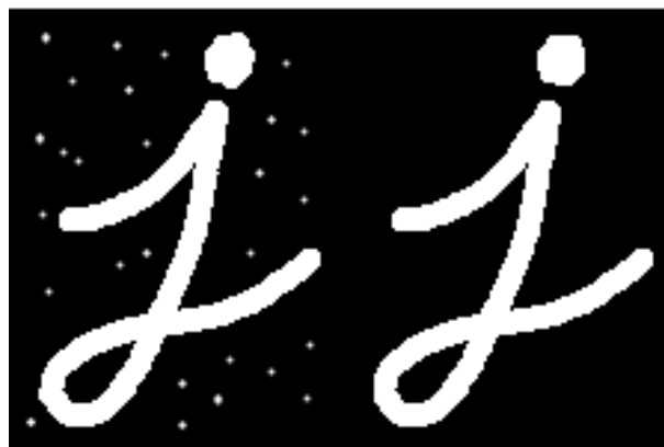
Abbildung 25 — Ein schwarz-weißes Bild vor dem morphologischen Öffnen (links) und nach dem Öffnen (rechts)
