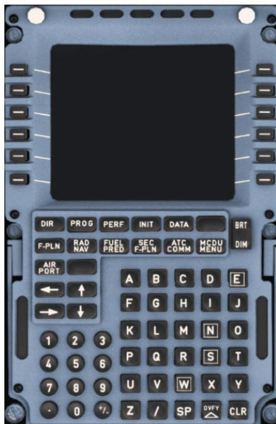
Abbildung 2-2: MCDU eines A320 (Quelle [9])
