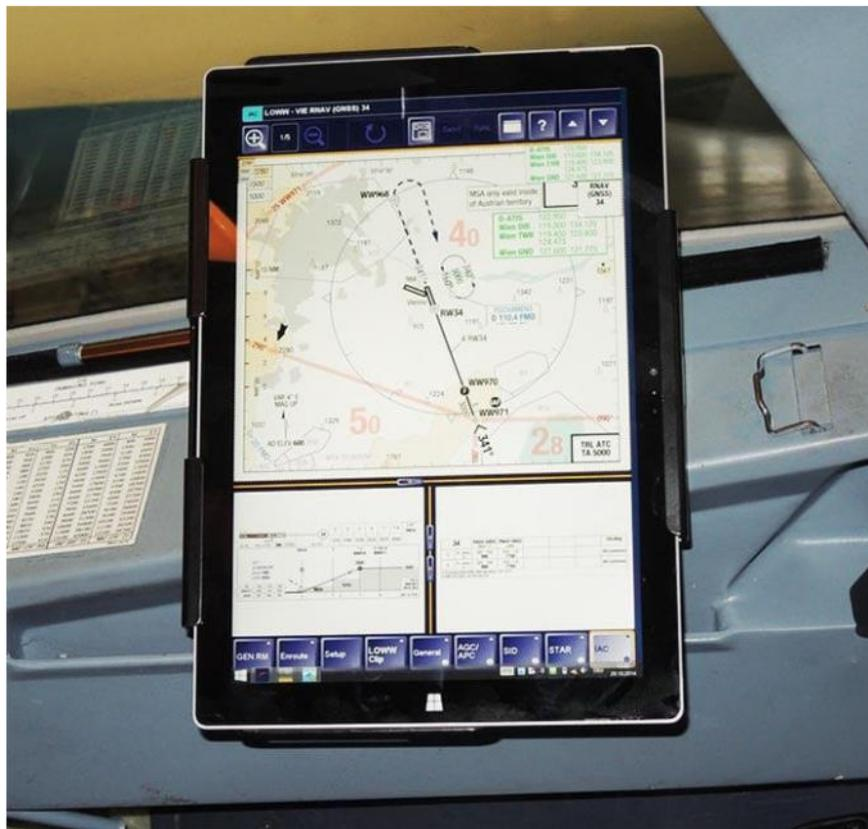
Abbildung 2-4: EFB des Typs B (Quelle [14])
