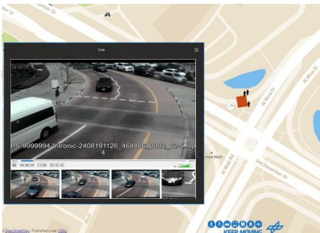
**Abbildung 7:** Gemeinsam mit VITRONIC wurde in KeepMoving ein Modul zur VRU-Warnung am Fußgängerüberwegen und OnDemand-Haltestellen entwickelt.
