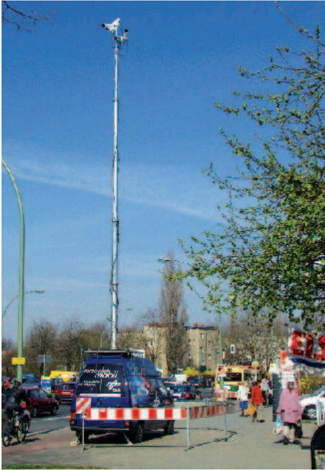
Abb. vorhergehende Seite und Abb links: Blick von oben – eines der Messfahrzeuge verfügt über einen dreizehn Meter hohen Teleskopmast, auf dem sich Kameras zur Verkehrsbeobachtung befinden.
