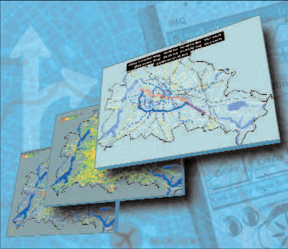
Abb. vorhergehende Seite: Hunderte von Taxis sammeln täglich Daten für die Verkehrsforscher. Abb. oben: Die drei Ebenen des Verkehrsinformationssystems: digitale Straßenkarte, Taxi Positionsdaten und Routenempfehlung. Abb. unten: Die Abbildung zeigt die Verkehrssituation in Berlin während der morgendlichen Rushhour an einem typischen Werktag. Grün bedeutet freie Fahrt, rot Stau.
