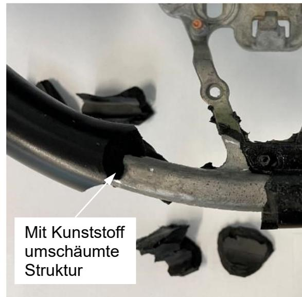
Abbildung 3.4 Detailaufnahme umschäumte Struktur aus Magnesium
