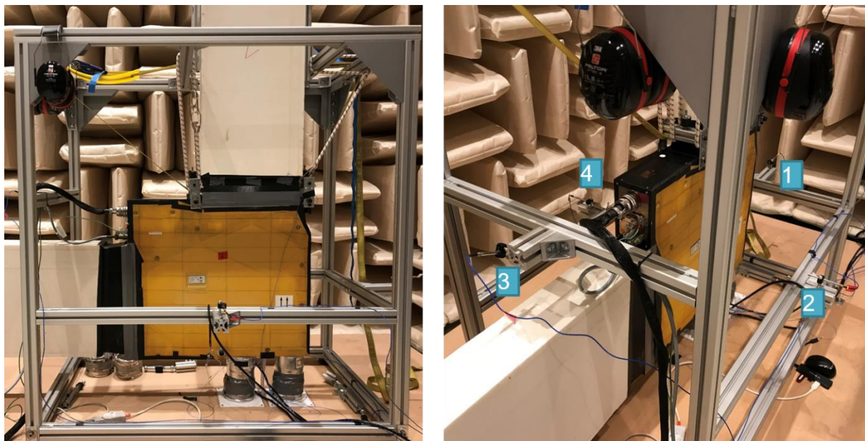
Abbildung 4: Setup für Baseline-Messung mit Mikrofonen. Schalldruckmessung an vier definierten Stellen um die ARU herum.
