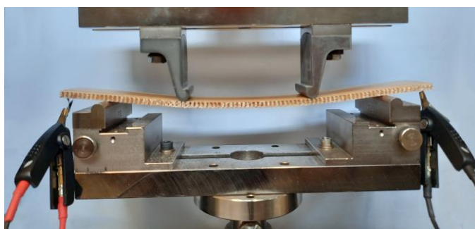
Abbildung 42: exemplarischen Aufbau der 4-Punkt-Biegeuntersuchung
