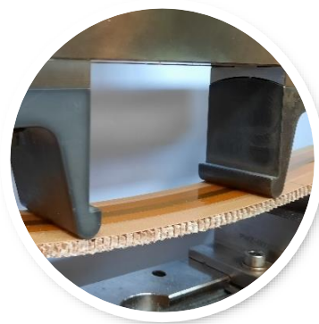
Abbildung 42: exemplarischen Aufbau der 4-Punkt-Biegeuntersuchung
