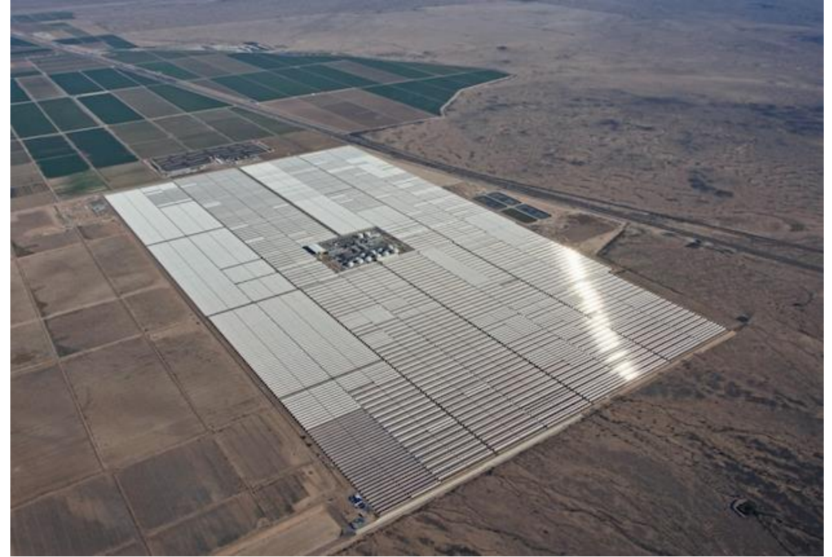
Solana (USA): 2.2 Millionen qm Kollektorfläche Elektrische Leistung 2x125 MW Speicherkapazität 10 h
