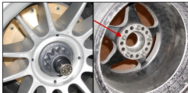
Abb. 2.12: Zentralverschraubung in Anlehnung an [6]
