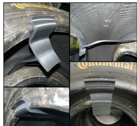
Abb. 3.38: Konturprüfung anhand des Continental C19 Reifens [42]
