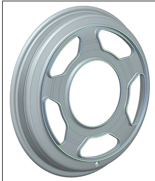
Abb. 3.41: Hohlraum in der Speichenfelge für einen Schaumkern [42]
