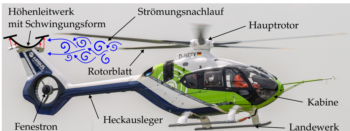
Abbildung 8.1: Grundlegende Komponenten des BLUECOPTER inklusive schematischer Skizzierung der untersuchten HLW-Mode. Die Verwendung und Anpassung des urheberrechtlich geschützten Bildes aus [3] wurde von AIRBUS HELICOPTERS genehmigt.
