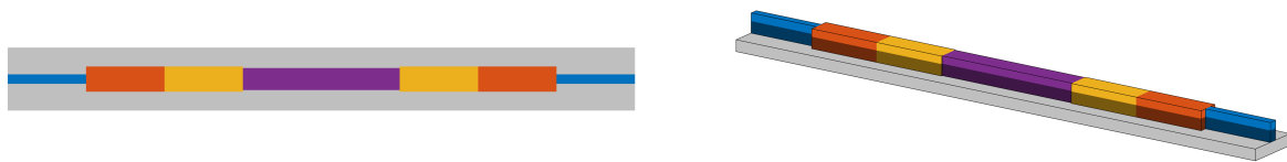
Abbildung 5.8: Optimales Design für H6 aus der ( links ) Drauf- und ( rechts ) Schrägsicht. Im Vergleich zur Referenzstruktur ist eine deutlich dickere Kernschicht erkennbar.
