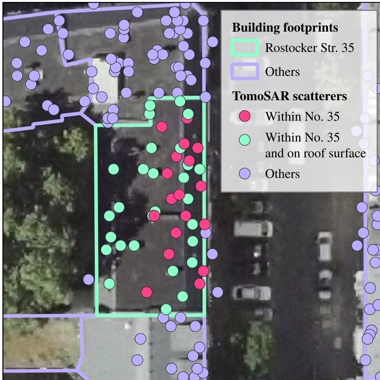
Figure 4.8.: TomoSAR scatterer selection for the building at Rostocker Str. 35. Background: © Geoportal Berlin / Digitale farbige TrueOrthophotos 2020 (True-DOP20RGB) - Sommerbefliegung), dl-de/by-2-0.
