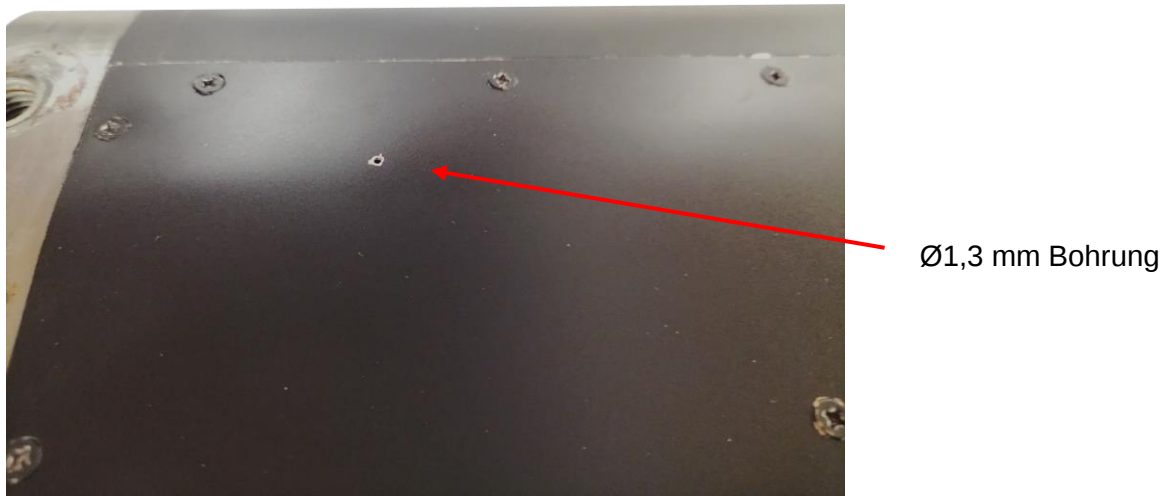
Abbildung 10: Ø1,3 mm Bohrung um Coversheet anzusaugen
