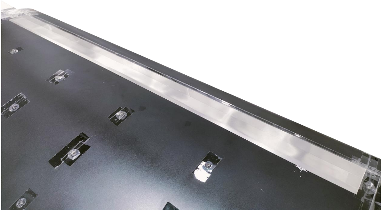
Abbildung 19: Coversheet und Upper-Inner Cover am Ende der Prüfreihe 1
