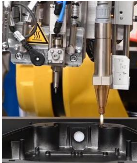
Abb. 6 Atmosphärendruckplasmagerät des Herstellers tantec bei der Vorbehandlung eines Kunststoffbauteils. [14]
