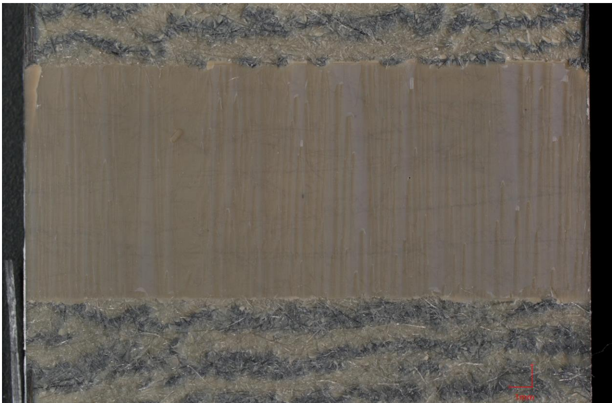
A 28 Mikroskopische Abbildung des Rissbilds der Probe TPU_6 über den Klebstoff im Bereich der Oberflächenzähmodifikation.
