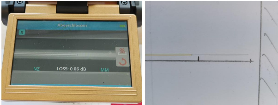
Abb. 29 Abbildung der mit kernloser Faser verspleißte Sensorfaser (links) in Betrachtung durch das Spleißgerät und (rechts) in Detail Aufnahme mit markierter Spleißstelle.
