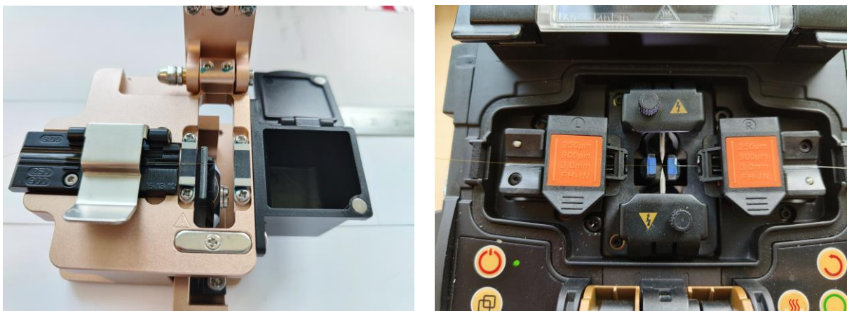
Abb. 28 Bilder des Schneidegeräts (links) und des Spleißgeräts (rechts) mit eingelegten Fasern.
