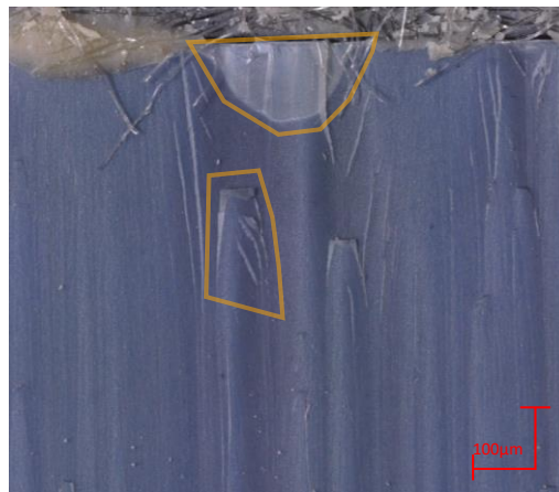
Abb. 71 Detailaufnahme zweier Risse innerhalb des TPUs am Anfang der Folie.
