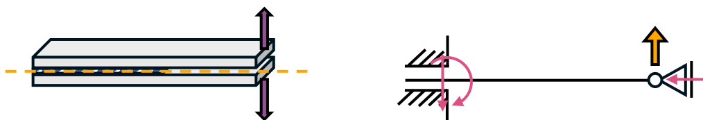
Abb. 21 Vereinfachte schematische Darstellung einer DCB-Probe als zwei miteinander verbundener Balken (links) und einer Probenhälfte als vereinfachter Balken mit wirkenden Kräften und Momenten(rechts).
