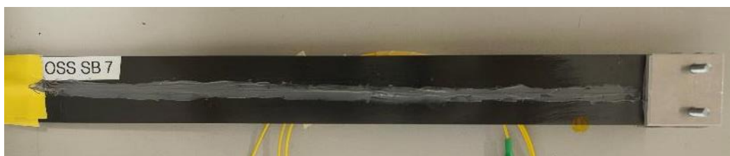
Abb. 36 DCB Probe mit aufgeklebter Scharnier Vorrichtung und FOSS-Faser auf der Oberfläche.
