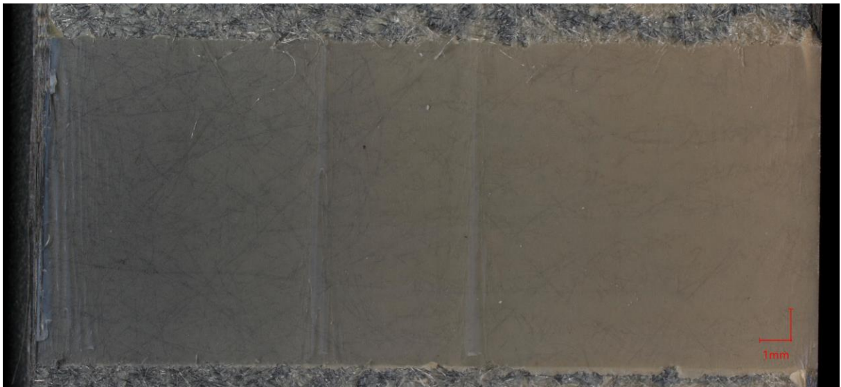
A 26 Mikroskopische Abbildung des Rissbilds der Probe TPU_5 über den Klebstoff im Bereich der Oberflächenzähmodifikation.
