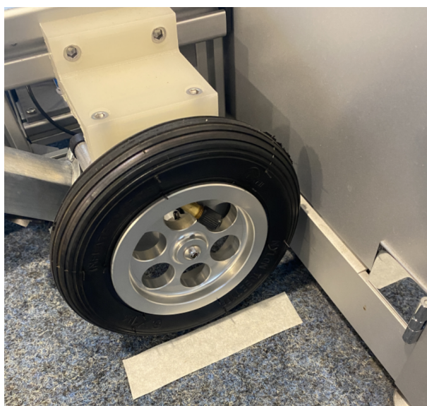
Abbildung 4.5: Bodenmarkierung der Initialposition beim Start des Versuchs
