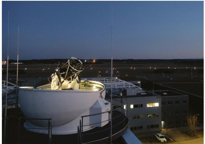
**Abb. 3 Experimentelle optische Empfangsstation des DLR in Oberpfaffenhofen**
