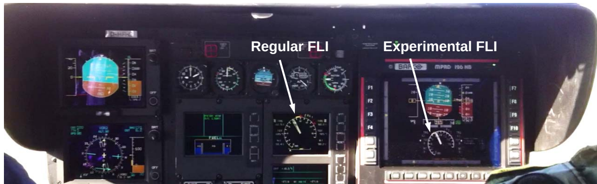
Abbildung 5.4.: Originale (mittig, „regular“) und experimentelle (rechts, „experimental“) FLI-Anzeigen im ACT/FHS-Cockpit
