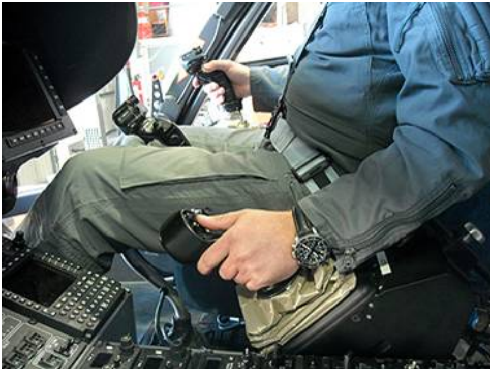
Abbildung 5.2.: Ergonomie linker Sidestick im ACT/FHS, nach vorne geneigt, Arm auf Arm-auflage
