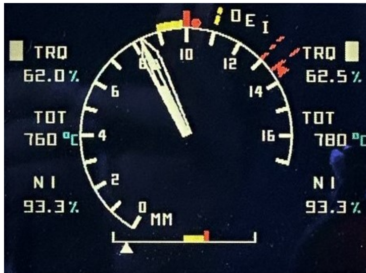
Abbildung 3.5.: FLI Triebwerksanzeige im ACT/FHS
