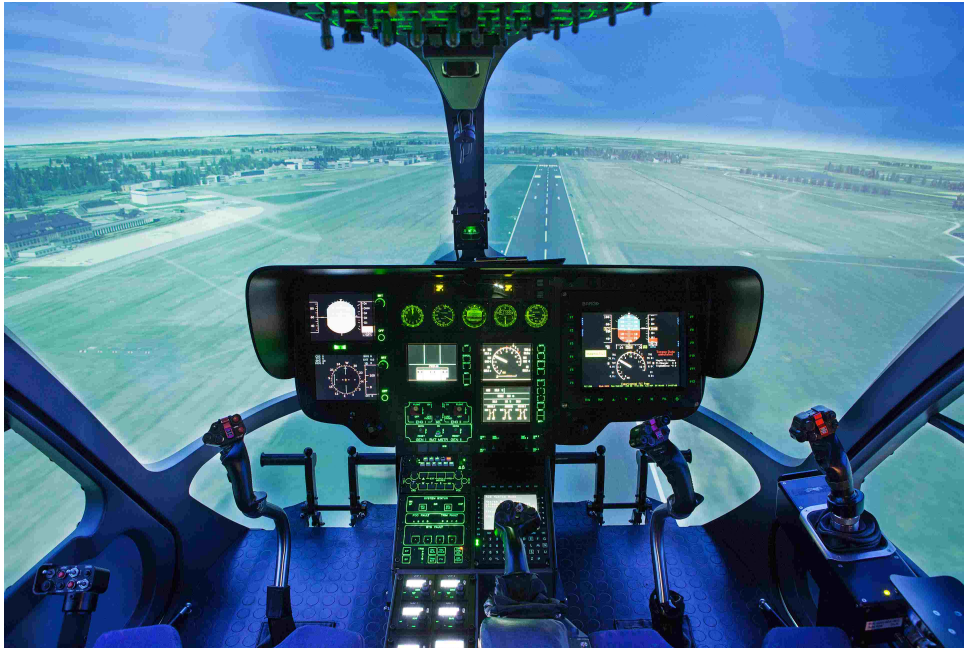
Abbildung 6.3.: AVES H135 Cockpit mit aktiven Sidesticks und experimentellem FLI Display am rechten Pilotensitz
