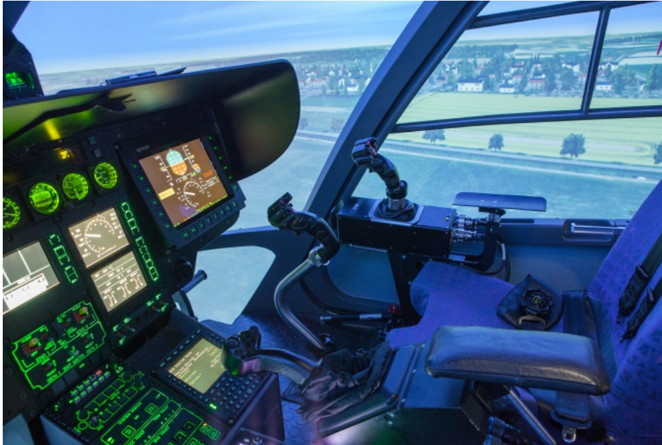
Abbildung 3.4.: Fly-side-by-side im ACT/FHS und AVES: Aktiver Sidestick links (Bild Vordergrund) und rechts (Bildmitte), dazwischen der Centerstick
