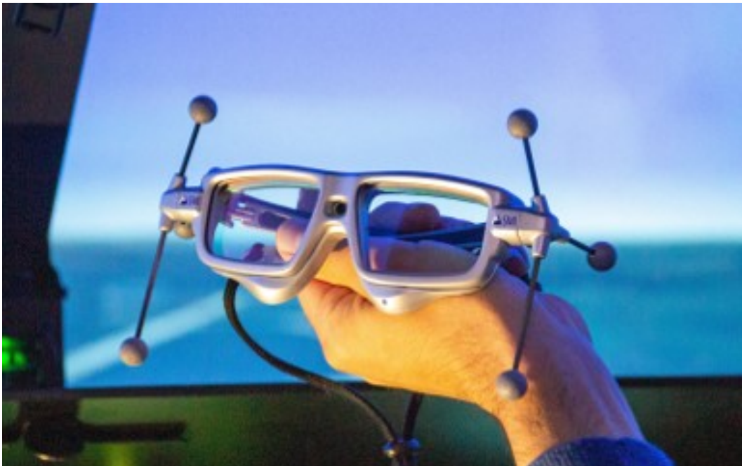
Abbildung 7.6.: Eyetracking -Brille der Firma SMI mit geweihförmigem Marker für den Head-tracker
