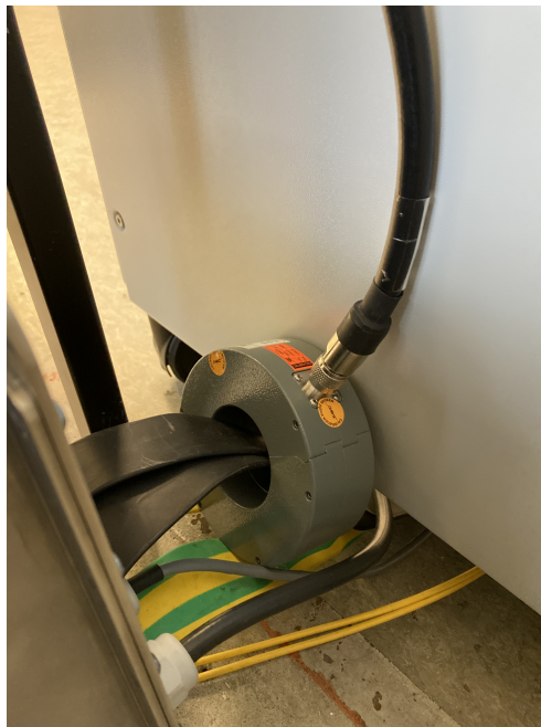
Abbildung 10: Abbildung der Stromzange in der FE-Erdleitung des Prüflingsmotors (Quelle: DLR, Braunschweig)
