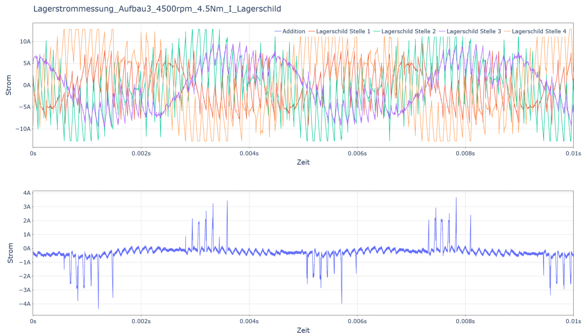
Abbildung 25: Messung des Lagerstroms mit der Speichen-Messmethode
