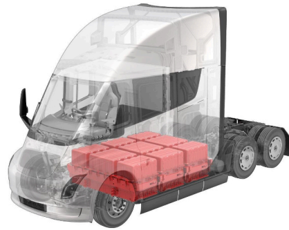
Abbildung 53: Tesla Semi Batteriepack 66
