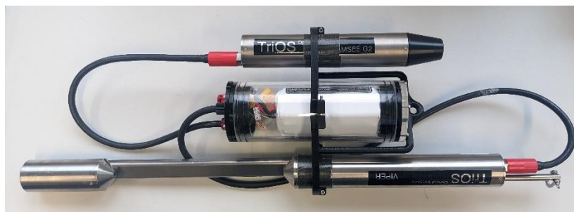
Abbildung 28: Einfache Konfiguration eines einzelnen RAMSES-Radiometers (oben) mit dem VIPER-Transmissiometer (unten) versorgt über ein Akkupack (mittig).
