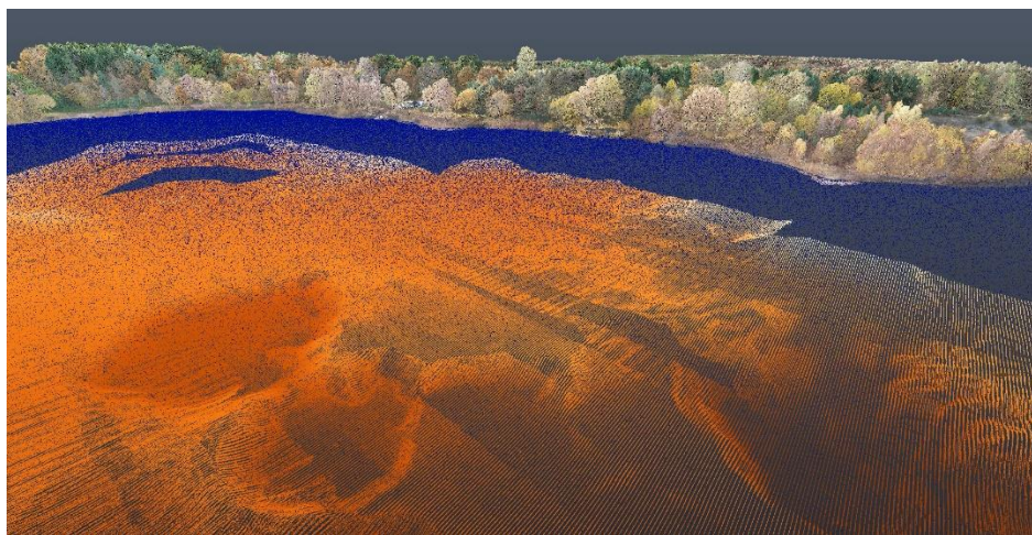
Abbildung 33: Punktwolken-Darstellung der Baggersee-Vermessung mit dem Multibeam der Seekatze.
