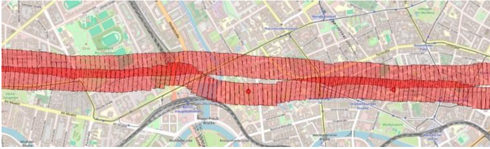
Abbildung 38: Typischer Abriss eines Bildverbandes ("Loch") durch starke Flugbewegung und unzureichend geplante Querüberlappung (x-track Overlap).
