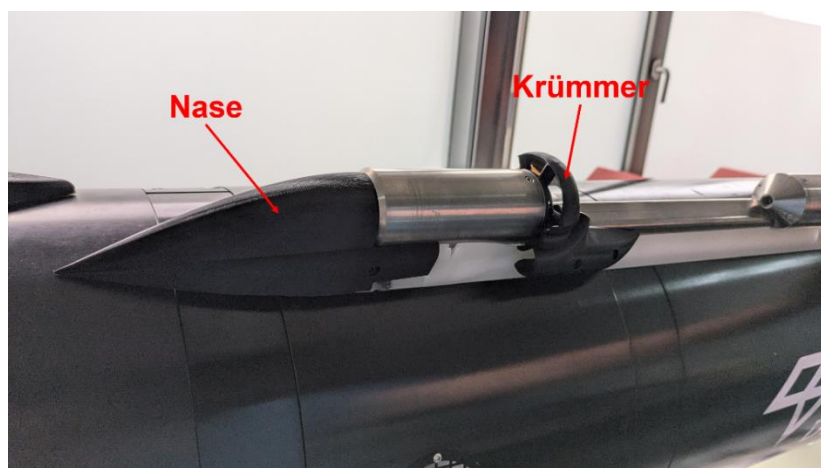
Abbildung 27: Strömungsoptimierte AUV-Sensorhalterung für den TriOS Viper Transmissionsensor.
