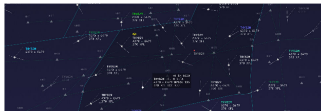
BILD 5. Durch das kontrastarme Grund-Layout sind Warnungen und Status der Luftfahrzeuge schnell zu erkennen.
