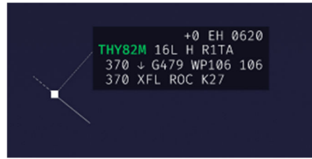
BILD 9. Die Farben des Track-Label Designs markieren in Abhängigkeit der Verkehrsbelastung unterschiedliche Flugzeugzustände.
