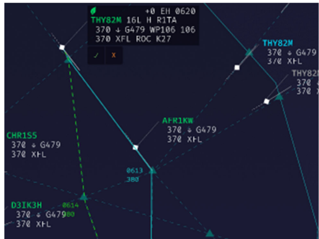
BILD 11. Die Layout-Modelle ermöglichen die Integration von erweiterten Unterstützungssystemen wie Arrival Manager und Freigaben über CPDLC. Auf der Grundlage von Flugbahnen werden Konflikte erkannt und mit integriertem MTCD und STCA in Kombination mit Vorschlägen zur Lösung der Konflikte oder zur Optimierung der Flugrouten angezeigt.
