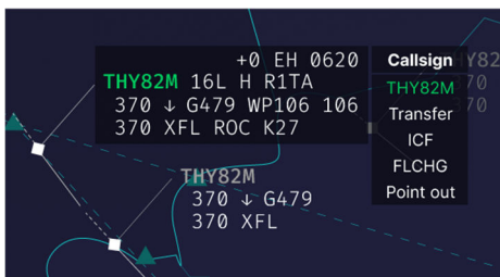
BILD 8. Die Track-Label als Informationsquelle und Interaktionselement wurden in den Mockups für zwei verschiedene Menüstile erstellt. Sich öffnende Menüs waren interaktiv und der Status der Track-Labels konnte durch Auswahl des Menüeintrags geändert werden. Die Probanden nutzten und bewerteten beide Versionen.
