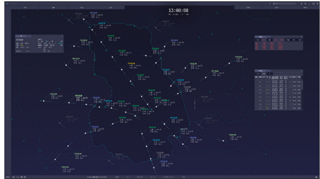
BILD 10. Mithilfe des Floating-Window-Layouts ist es möglich, zusätzliche Informationen anzuzeigen und nahezu komplett frei auf dem Radarbildschirm zu platzieren. Abhängig von der Sektorstruktur kann so die Bildschirmfläche optimal ausgenutzt werden, ohne die Überlagerung wichtiger Informationen zu riskieren.
