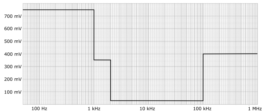
Abbildung 4.13: Spannungsprofil des injizierten Signals
