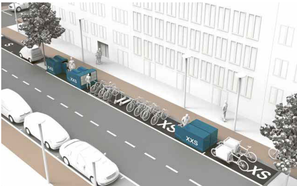
Abb. 59: FeinPark-Anlage mit beispielhafter Platzierung von Parkboxen zum Abstellen von Bewegungsmitteln der G-Klassen XXS und XS im Straßenraum (© Copyright 2024 WSM Walter Solbach Metallbau GmbH)*
