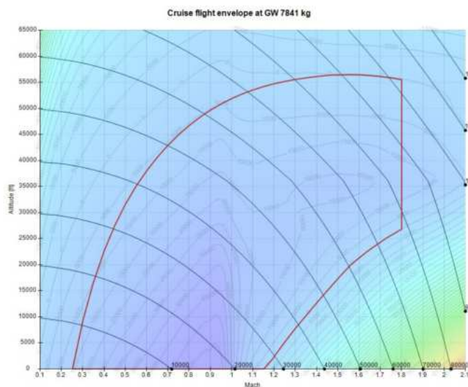
Abbildung 7.6: Flugumhüllung und Schubüberschuss des Turmfalke V1
