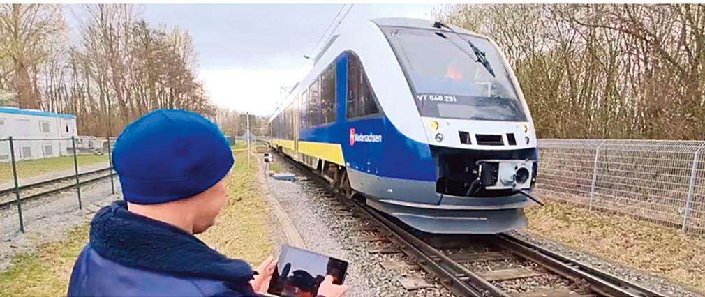
Abb. 2: Lokale Fernsteuerung des Fahrzeugs
