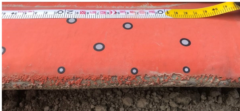
Abbildung 2.6: Erosionsschäden an der Blattspitze bei 99 % Rotorradius
