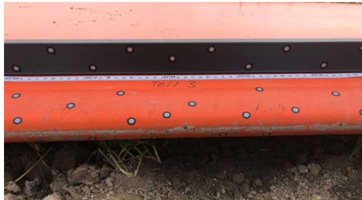
Abbildung 4.1: Referenzpunkte eines Blattabschnitts für den Scan der Vorderkante
